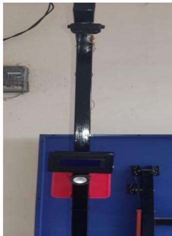
**Gambar 7** Alat pengukuran tinggi badan, berat badan dan suhu badan otomatis
