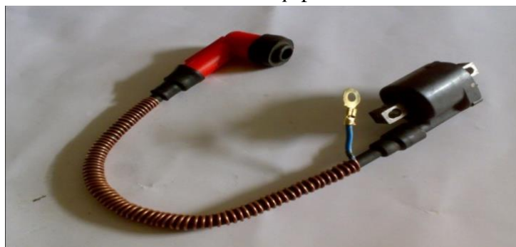
Gambar 1. Groundstrap pada Kabel Busi
