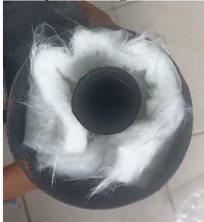
Gambar 5. Fibreglass wool yang sudah dianyam
