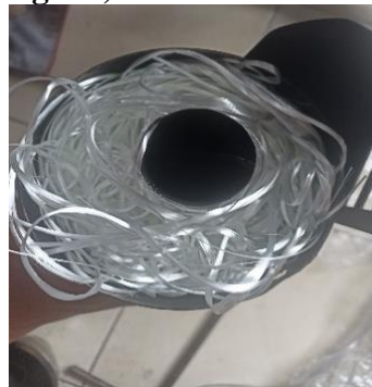
Gambar 3. Glaswool rambut nenek yang dipasangkan pada knalpot
