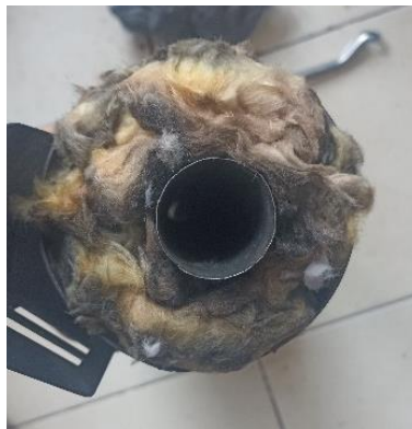
Gambar 2. Glasswool yang dipasangkan pada knalpot
