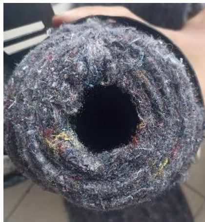
Gambar 6. Rockwool pada knalpot
