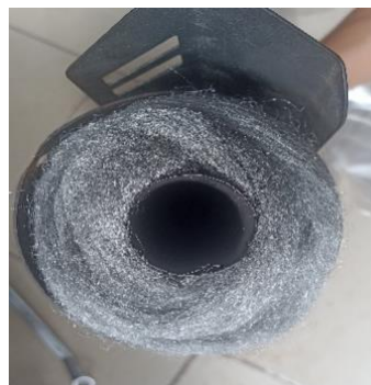
Gambar 4. Stainless wool yang dipasangkan pada knalpot
