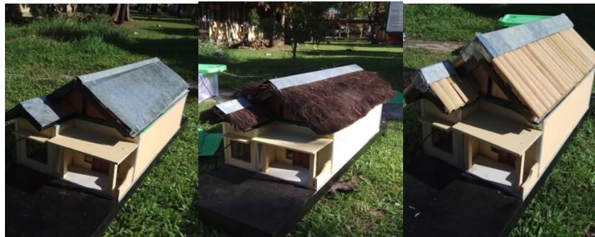
Gambar 2. Prototipe dengan material : (a) seng (b) ijuk dan (c) bambu
