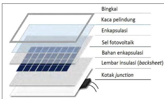
Gambar 5. Struktur modul Photovoltaic
