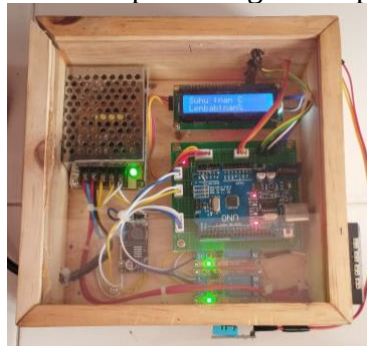
Gambar 3. Perancangan Alat Pengatur Suhu Kandang Otomatis
