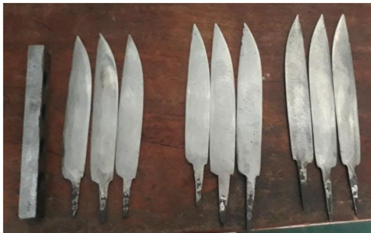
**Gambar 5.** Pisau yang akan diuji (a) quenching air es (b) quenching oli (c) quenching air laut
