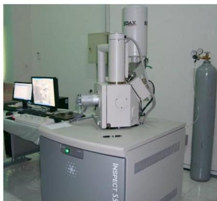
**Gambar 1. Alat SEM-EDX Mapping pada Lab Sentral Mineral dan Material Maju FMIPA Universitas Negeri Malang**
