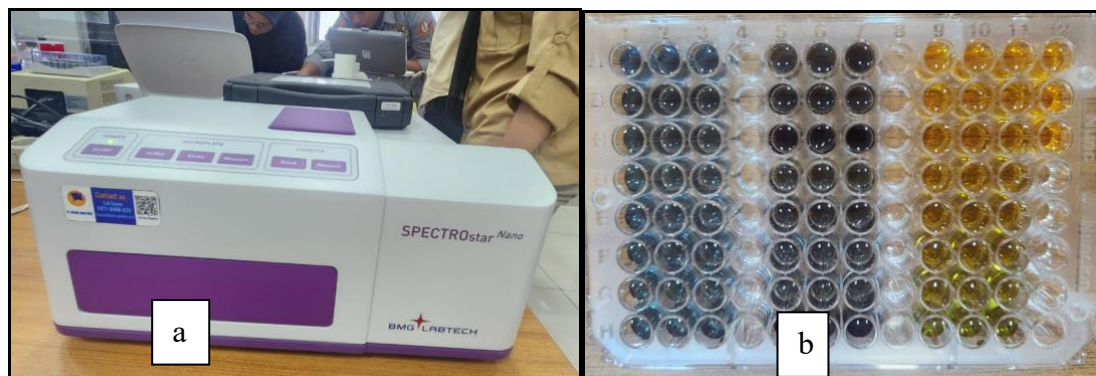
Gambar 5. (a). Instrumen Microplate reader absorbance (b) Sampel pada Microplate
