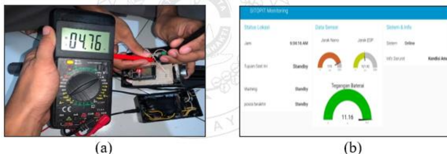
Gambar 4.27: (a) pengukuran tegangan INA219 (b) tampilan dashboard Sumber: dokumentasi penelitian
