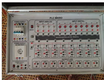
Gambar 2. Bagian bagian trainer PLC berbasis Microcontroller
