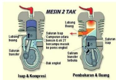
**Gambar 7. langkah kerja mesin 2 tak**
