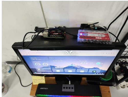
Gambar 4. Hardware Setup NAS dengan Raspberry Pi
